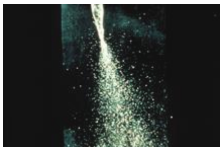
Gambar 13. Aerosol yang terbentuk karena proses pipetasi yang kurang tepat ( https://www.biosafety.be/ )
