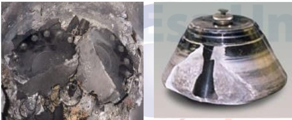
Gambar 12. Rotor pada mesin sentrifugasi yang mengalami kerusakan karena cara pemakaian yang tidak tepat ( https://spectrofuge.com/ ).
